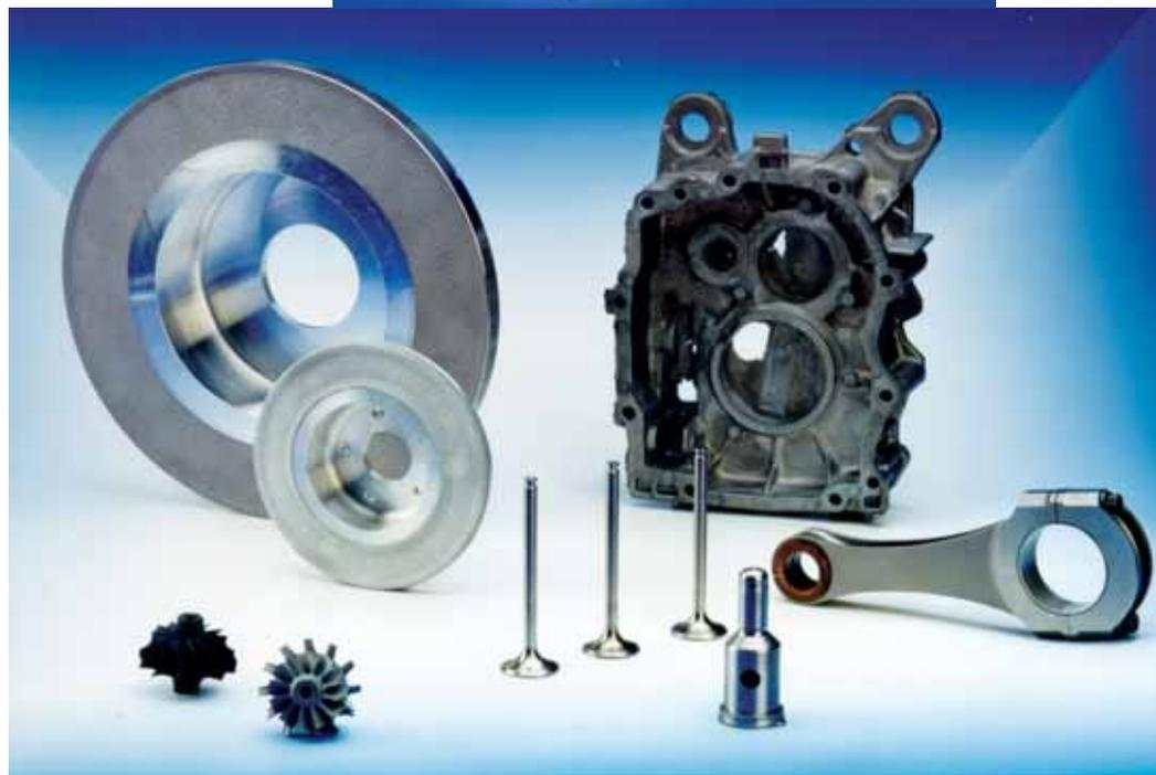
Beispiele metallischen Leichtbaus bei Motor- und Fahrwerkskomponenten: Getriebegehäuse aus Magnesium, Pleuel aus Titan, Ventile und Turboladerrotoren aus Titanaluminid und Bremsscheiben aus partikelverstärktem Aluminium
