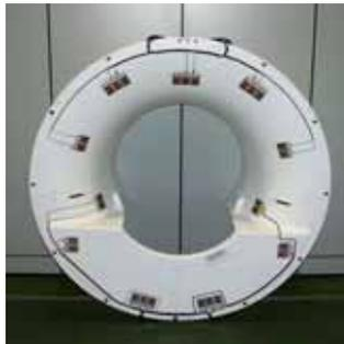
Links: PZT-Folien als Schwingungsdämpfungselemente aufgebracht auf den Trichter eines Magnetresonanztomographen. Die PZT-Folien bewirken eine erhebliche Geräuschdämpfung während der Patientenuntersuchung.
